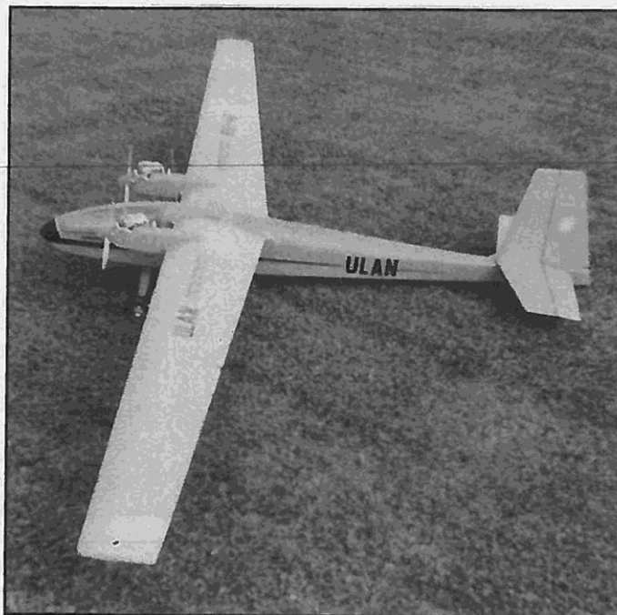
Motorsegler zweimotorig, mit abwerfbarem Hauptfahrwerk
