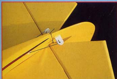
Les commandes sont de simples cordes à piano de 6/10 pliées.
