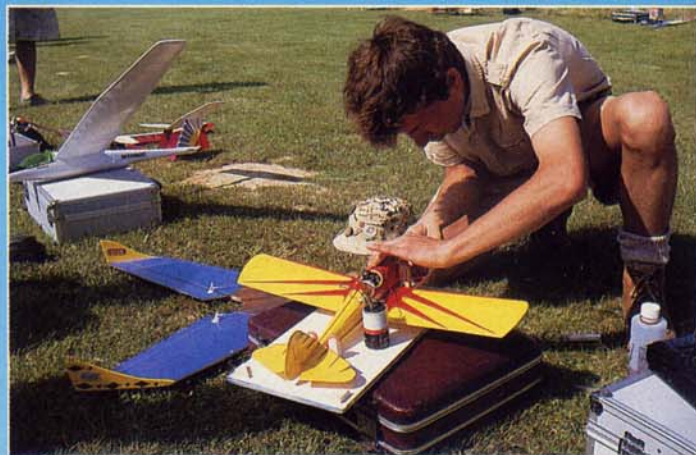
Notez la taille de l'accu de démarrage par rapport aux dimensions exceptionnellement modestes de cette maquette.
