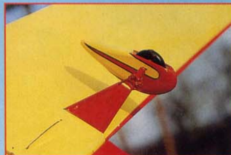
Les chapeaux de roues sont maintenus avec un bouton pression.
