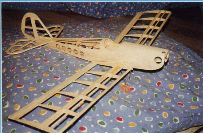
Le little Spacewalker est construit en structure ultra légère, ce qui permet d'obtenir un poids final surprenant : 160 grammes
