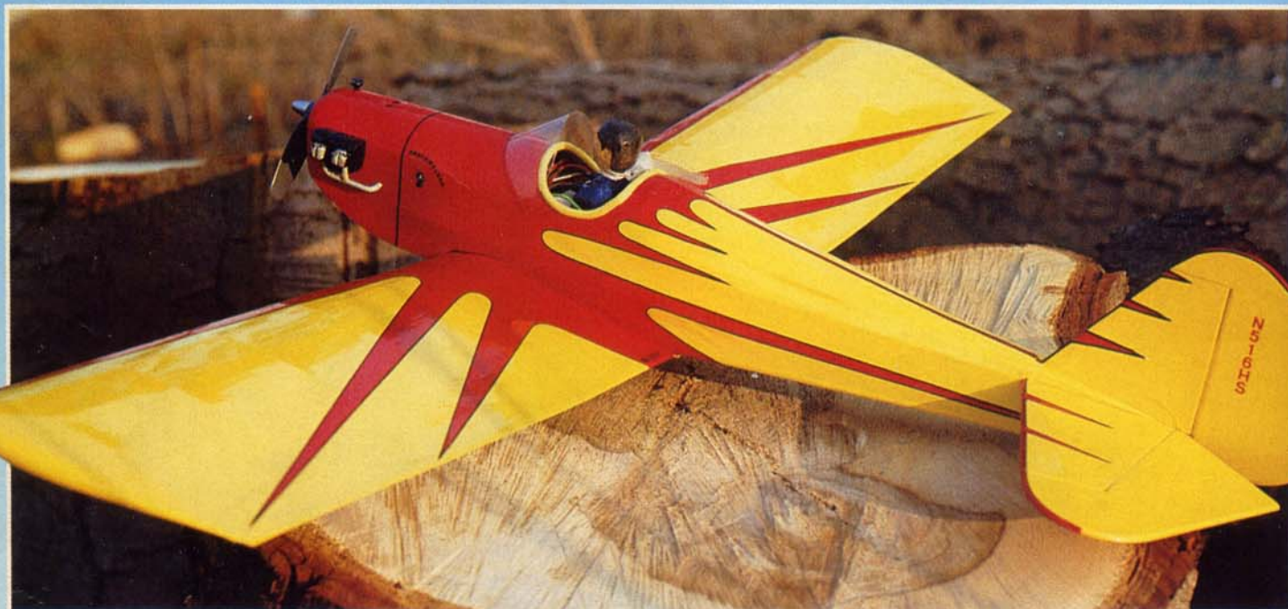
Le little Spacewalker est construit en structure ultra légère, ce qui permet d'obtenir un poids final surprenant : 160 grammes
