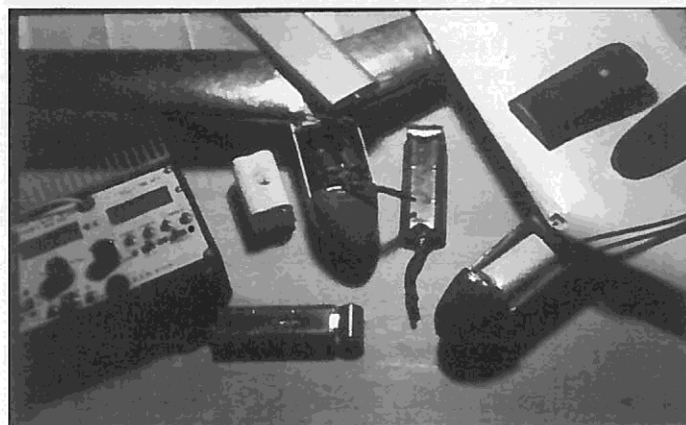
Der Rumpf nimmt Akkus sowohl in Stangen- als auch in Blockkonfiguration auf
