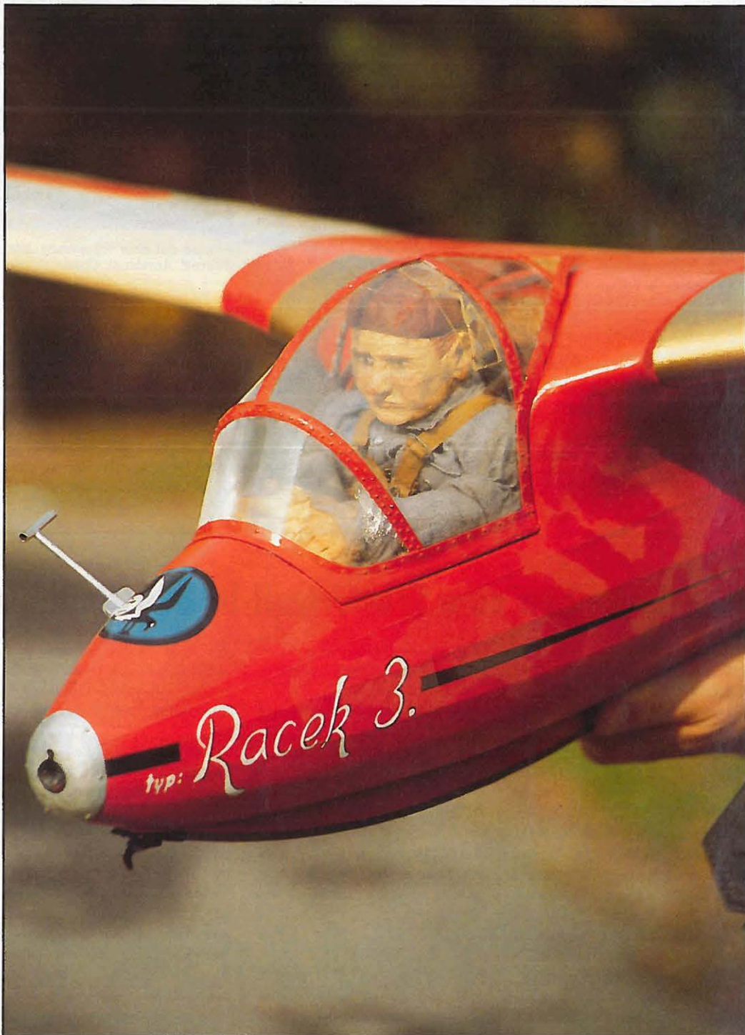
Viele, viele Stunden sind in die Kabinenhaube eingeflossen: Allein an die 80 kleine Alunieten mußten eingesetzt werden
