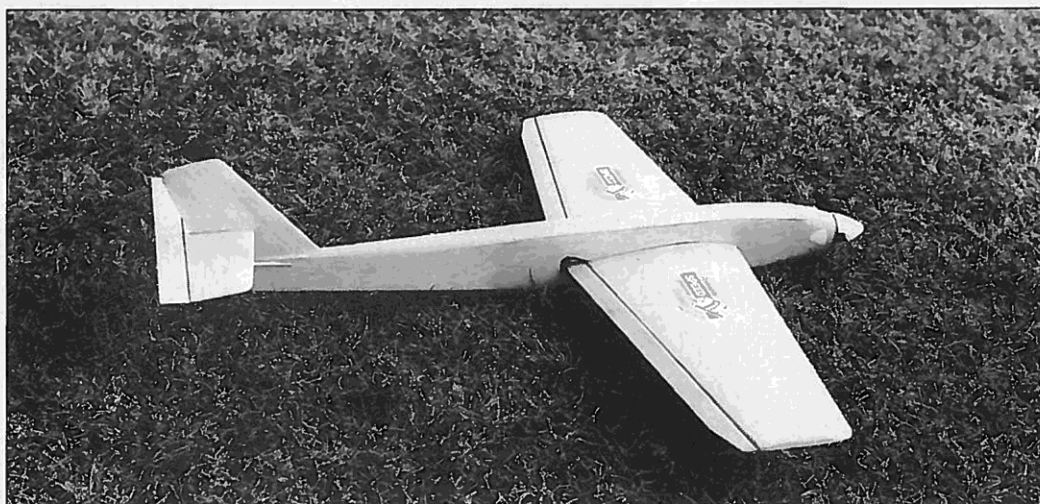
Die Kunst des Leichtbaus ist hier gefragt, um ein flottes, kunstflugtaugliches Modell zu haben. Die Mini-Schwalbe wiegt flugfertig 450 g
