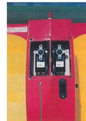
Die „RC-Zugänge“: Von der Unterseite des Rumpfs sind die Servos erreichbar, von der Frontseite, durch eine Öffnung im Spant, der Empfänger und der Akku
