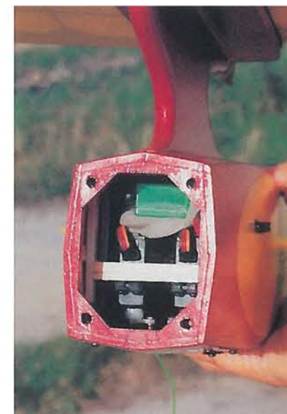
Die „RC-Zugänge“: Von der Unterseite des Rumpfs sind die Servos erreichbar, von der Frontseite, durch eine Öffnung im Spant, der Empfänger und der Akku
