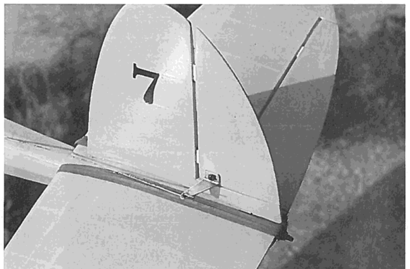
Das Leitwerk hatte in der ersten Version nur ein Höhenruder; besser ist es jedoch, seine beiden Hälften anzulenken
