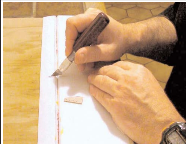
Encocher la gouverne de profondeur pour insérer le guignol (contreplaqué 10/10e ou carte téléphonique).
