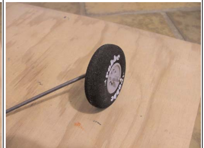
Les arrêts de roues : un simple tube d'aluminium, une goutte de colle cyanoacrylate (sans coller la roue !) et un coup de pince pour écraser le tout.
