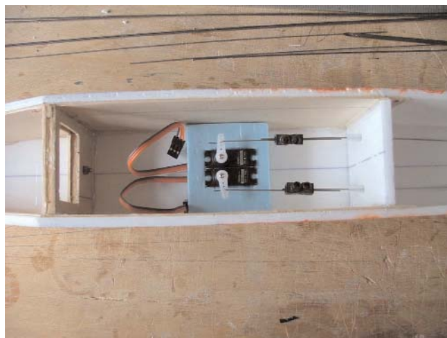
Gros plan sur le système de réglage des commandes (rustique mais efficace). Le bloc servos est collé sur le fond par du double face et assuré par deux traits de colle fusible dans les angles.
