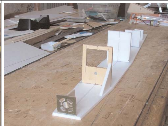
Cette autre vue montre le détail du couple C1 ainsi que les repères de mise en place des couples sur le fond du fuselage.
