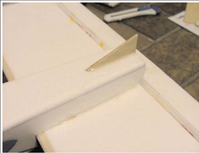
La béquille en contreplaqué 20/10e est collée à l'époxy rapide ou à la colle fusible).
