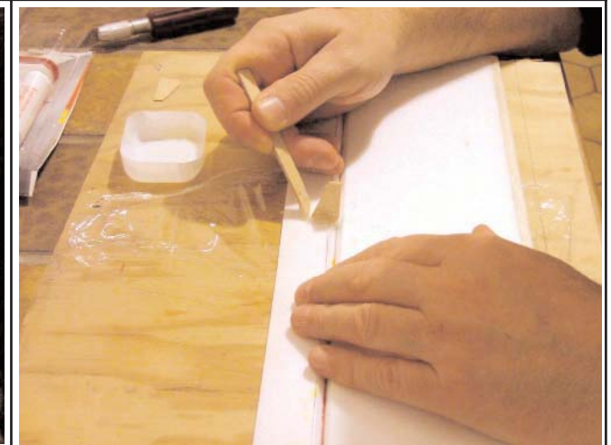
Collage du guignol à l'époxy rapide. Noter le morceau de film alimentaire qui protège le chantier
