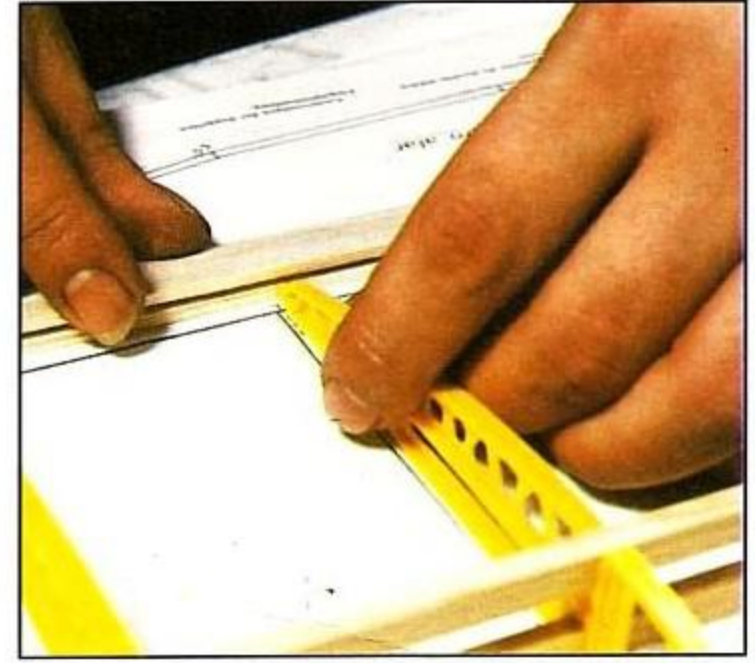
El borde de salida tiene una ranura prevista para encajar también las costillas.
