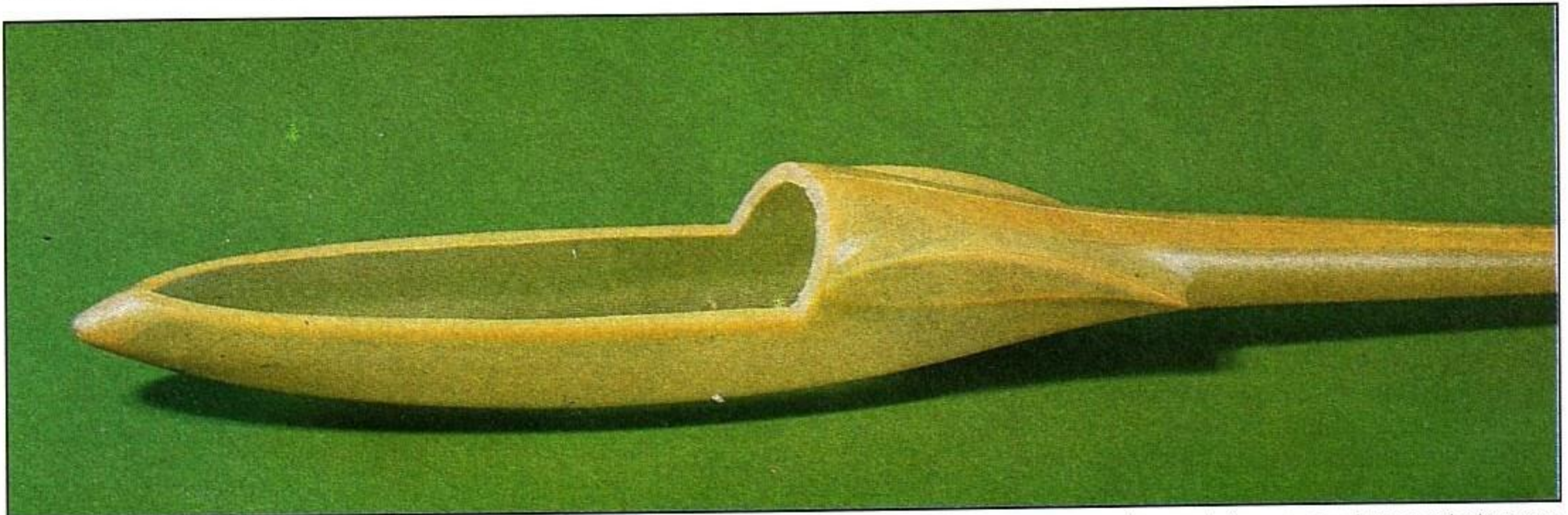
Parte anterior de un fuselaje realizado en fibra de vidrio con resina epóxica. Un sistema con grandes ventajas por su dureza y bajo peso.
