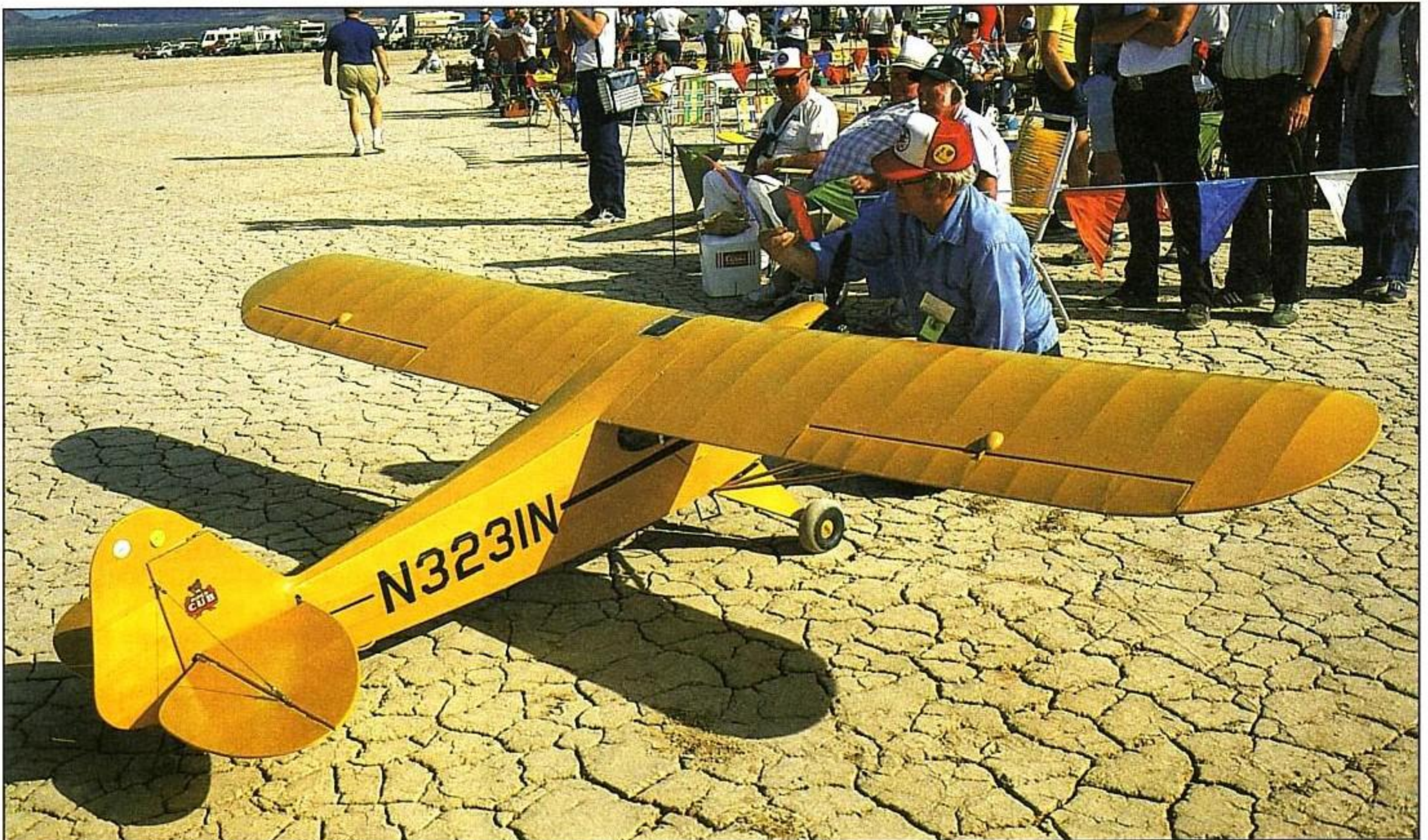
El Piper «Cub» es un modelo clásico en el que se aprecia claramente el recubrimiento de tela en su fuselaje, alas y estabilizadores.
