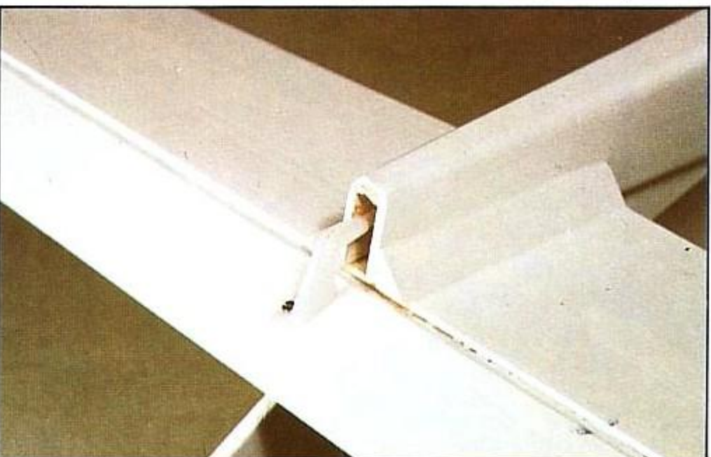
14. La misma operación se realiza con el timón de profundidad. Asegurarse de la buena fijación de estas piezas.
