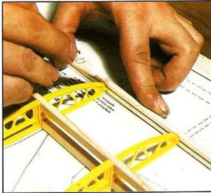
La misma operación se repite con el borde de ataque, encajándolo en su sitio.
