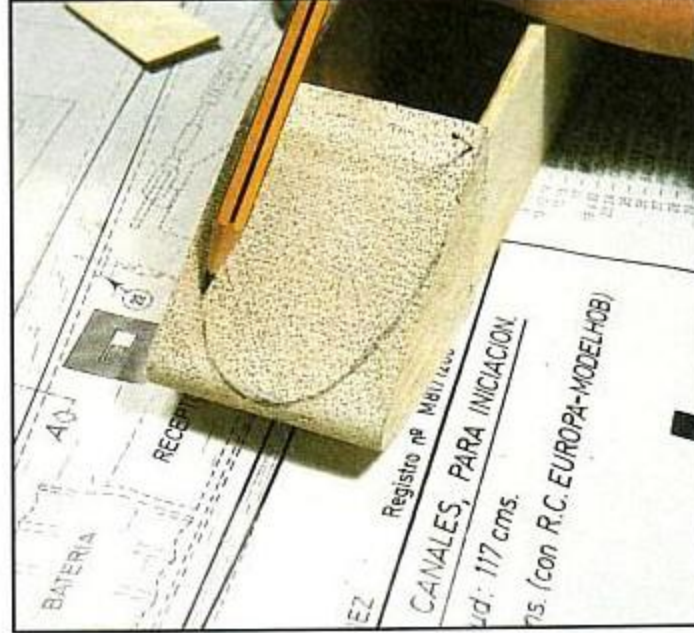
16. En el morro se traza una línea por donde más tarde lijaremos hasta conseguir su forma definitiva.
