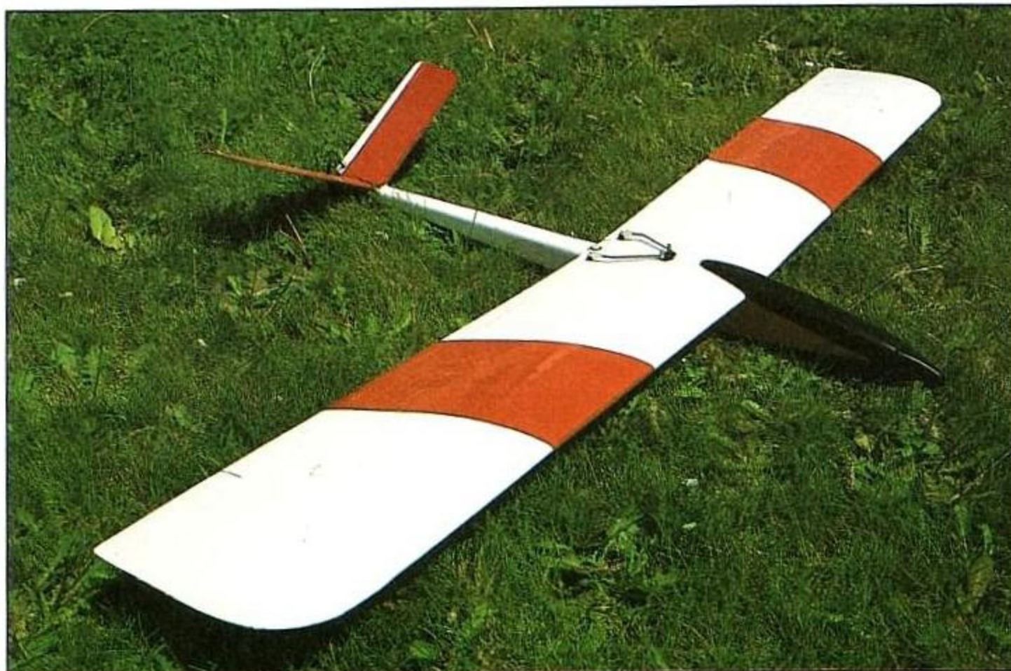
Velero con alas enchapadas en madera, y recubiertas con plástico termo-adhesivo.
