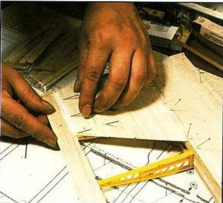
Completar el enchapado de la zona central de las alas y fijar con alfileres.
