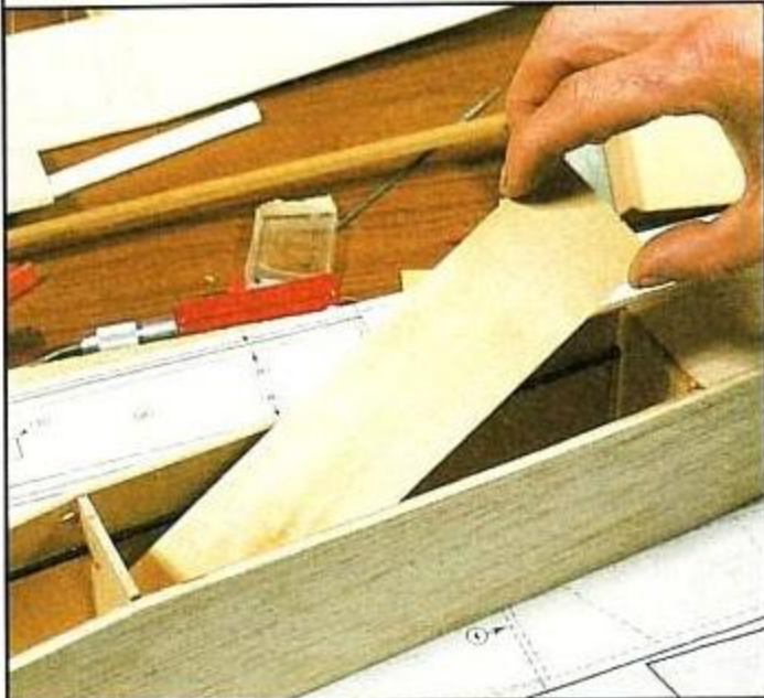
15. El «suelo» del fuselaje va reforzado con unas piezas de contrachapado que encolaremos fijándolas mediante un peso.
