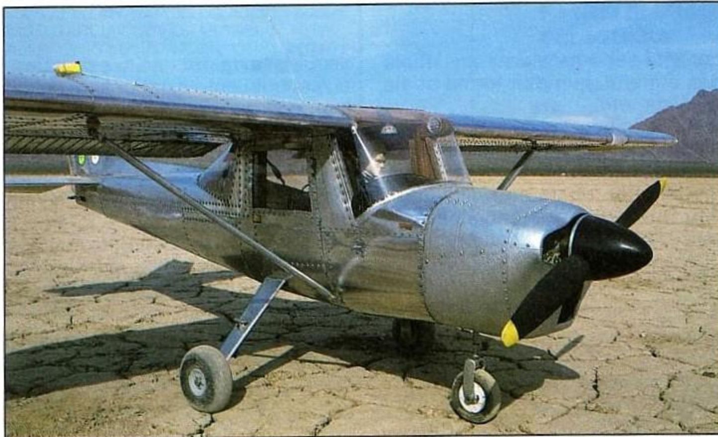
El recubrimiento de aluminio es poco usual en aeromodelismo, por sus limitaciones.
