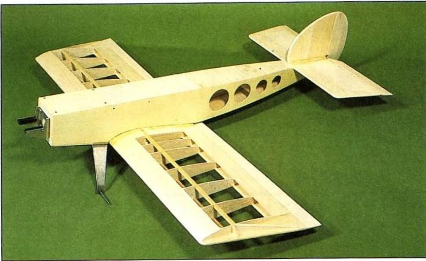
Una estructura rígida puede ser entelada con papel grueso, tela o recubrimiento plástico.
