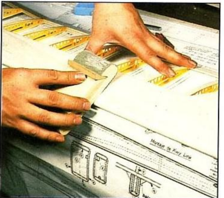
Una vez enchapada la parte superior se da un lijado general para ajustar las uniones.
