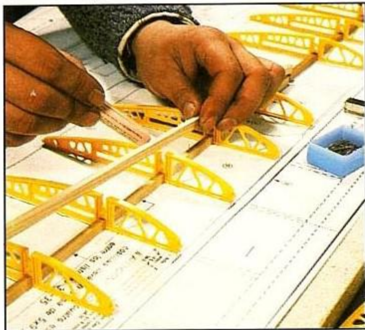
El larguero superior se pega encajándolo en el alojamiento correspondiente.
