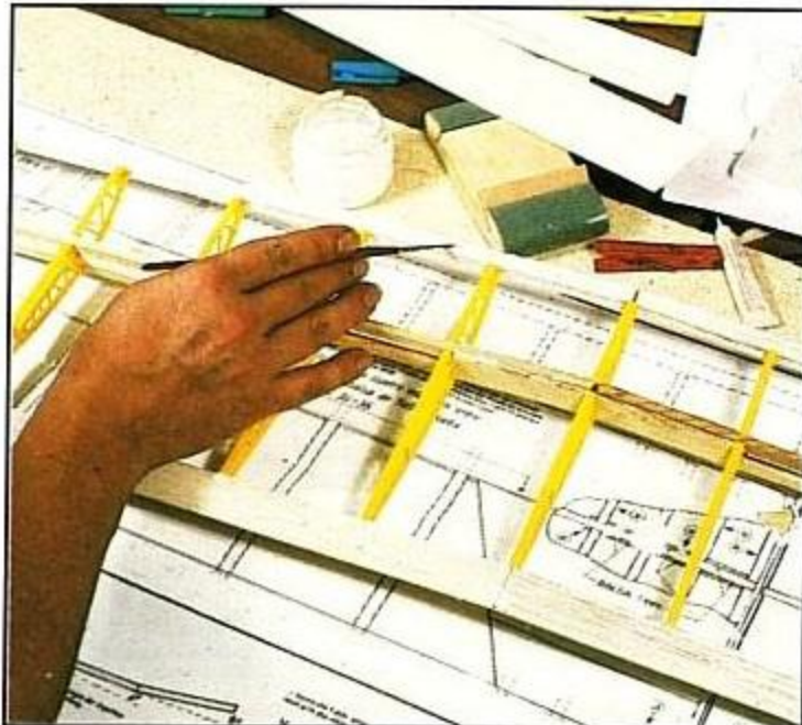
Se aplica cola blanca en el rebaje del borde de ataque para pegar el enchapado inferior.
