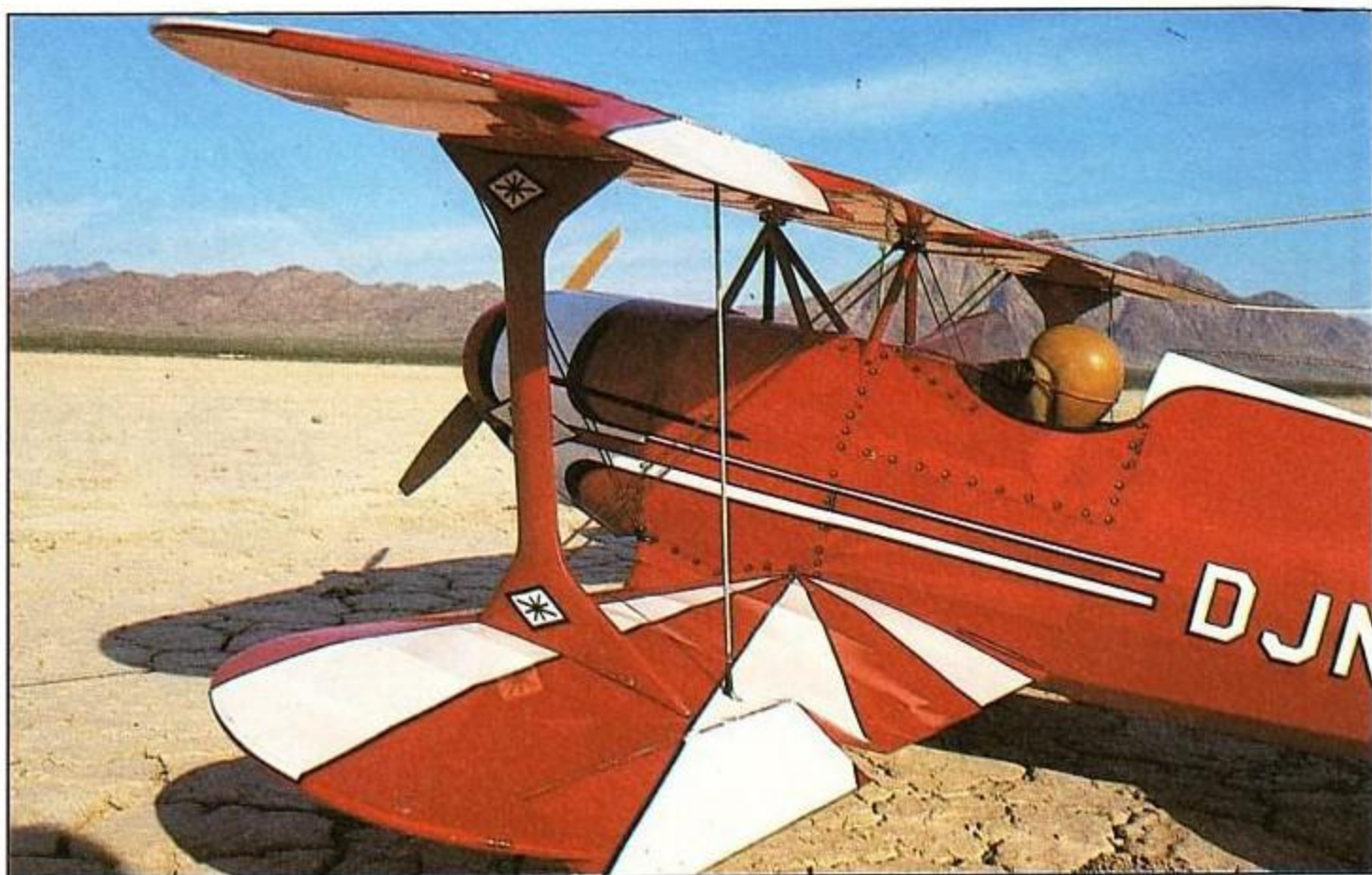
Este Pitts está recubierto con tela, excepto la parte anterior del fuselaje que lleva aluminio.
