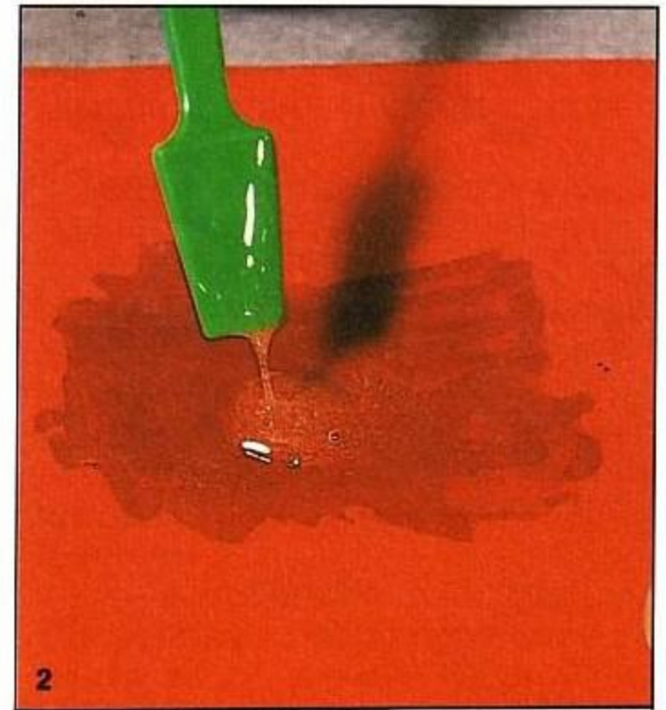
1.ª operación: se extienden los dos componentes a partes iguales, procurando después no invertir los tapones. 2.ª operación: se mezclan insistentemente con ayuda de una pequeña paleta, y está ya listo para aplicar.
