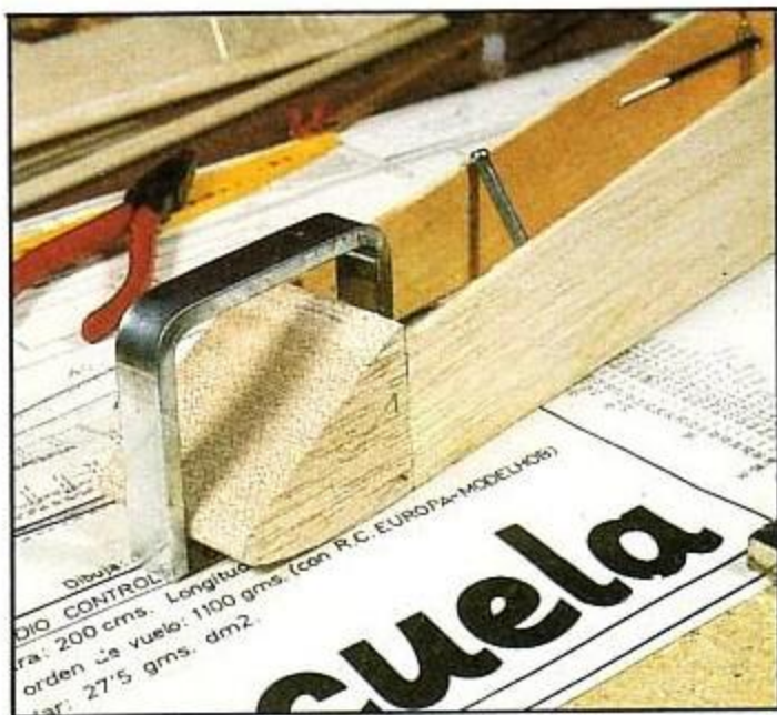
12. Encolar y fijar mediante un gato, el taco de balsa previsto para el morro del modelo. Más tarde se dará forma utilizando una lima.
