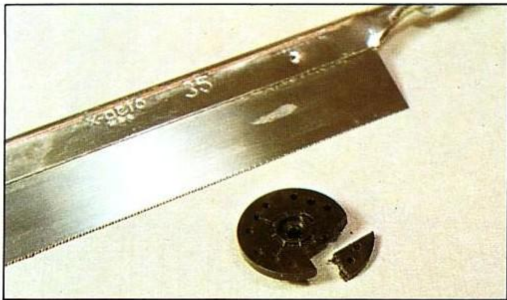
7. Si el brazo del servo es circular, deberá cortarse un sector para facilitar el desplazamiento del kwik link.
