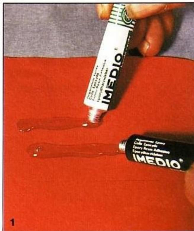
1.ª operación: se extienden los dos componentes a partes iguales, procurando después no invertir los tapones. 2.ª operación: se mezclan insistentemente con ayuda de una pequeña paleta, y está ya listo para aplicar.
