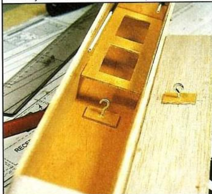
18. En el interior hay otro refuerzo con un gancho, donde se sujetará la goma que cierra la cabina.
