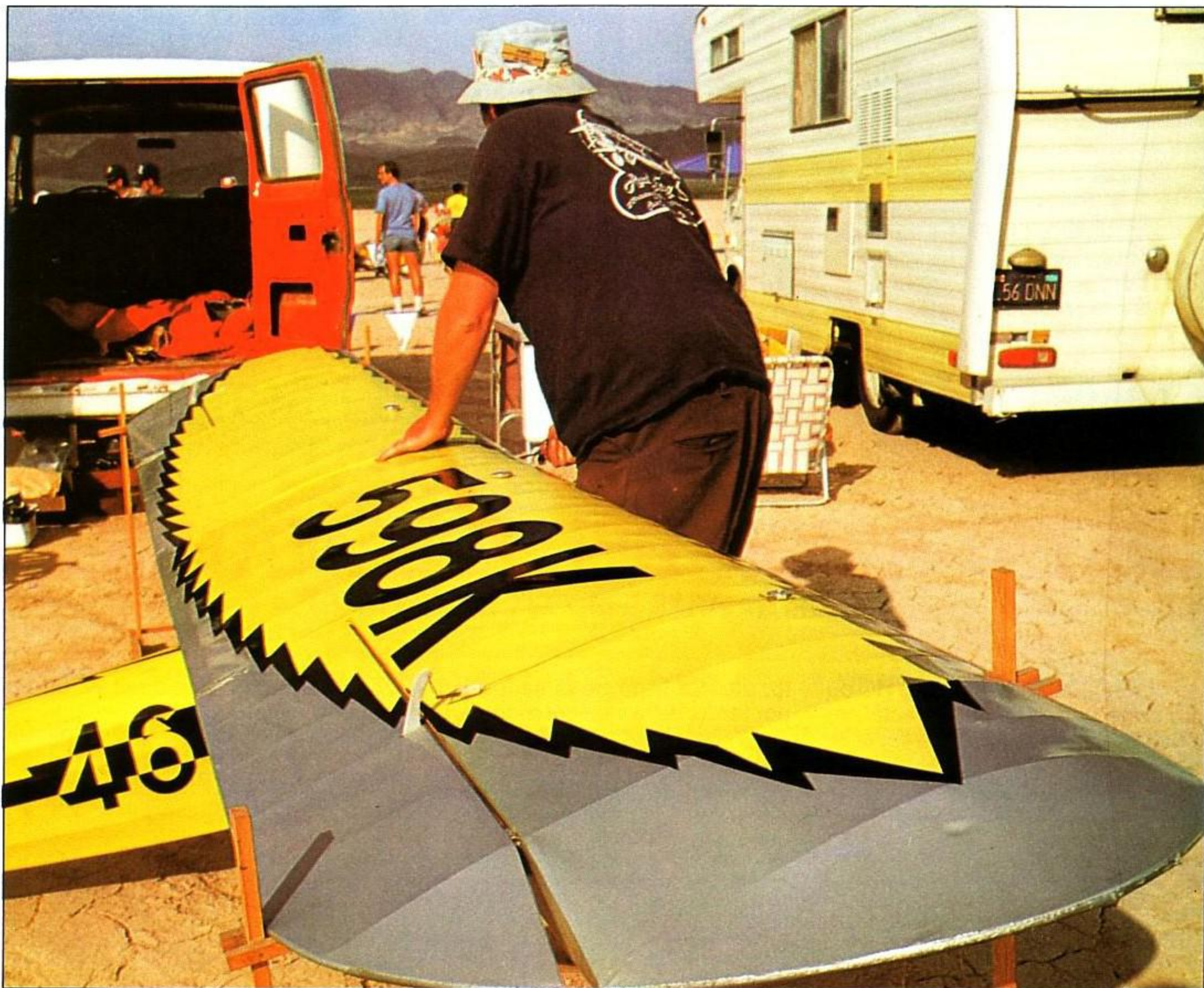
Gigantesco modelo con los cables de mando en el exterior del ala, guiados por unas poleas. Es una reproducción del modelo real.
