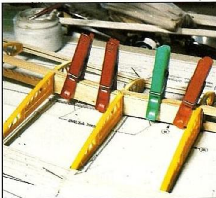
Los largueros, que previamente se habrán cortado, se unen mediante los refuerzos con el ángulo correcto. Utilizar epoxy.
