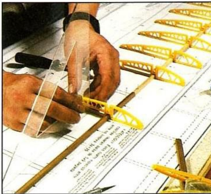
Mediante una escuadra comprobaremos la situación correcta a 90°.
