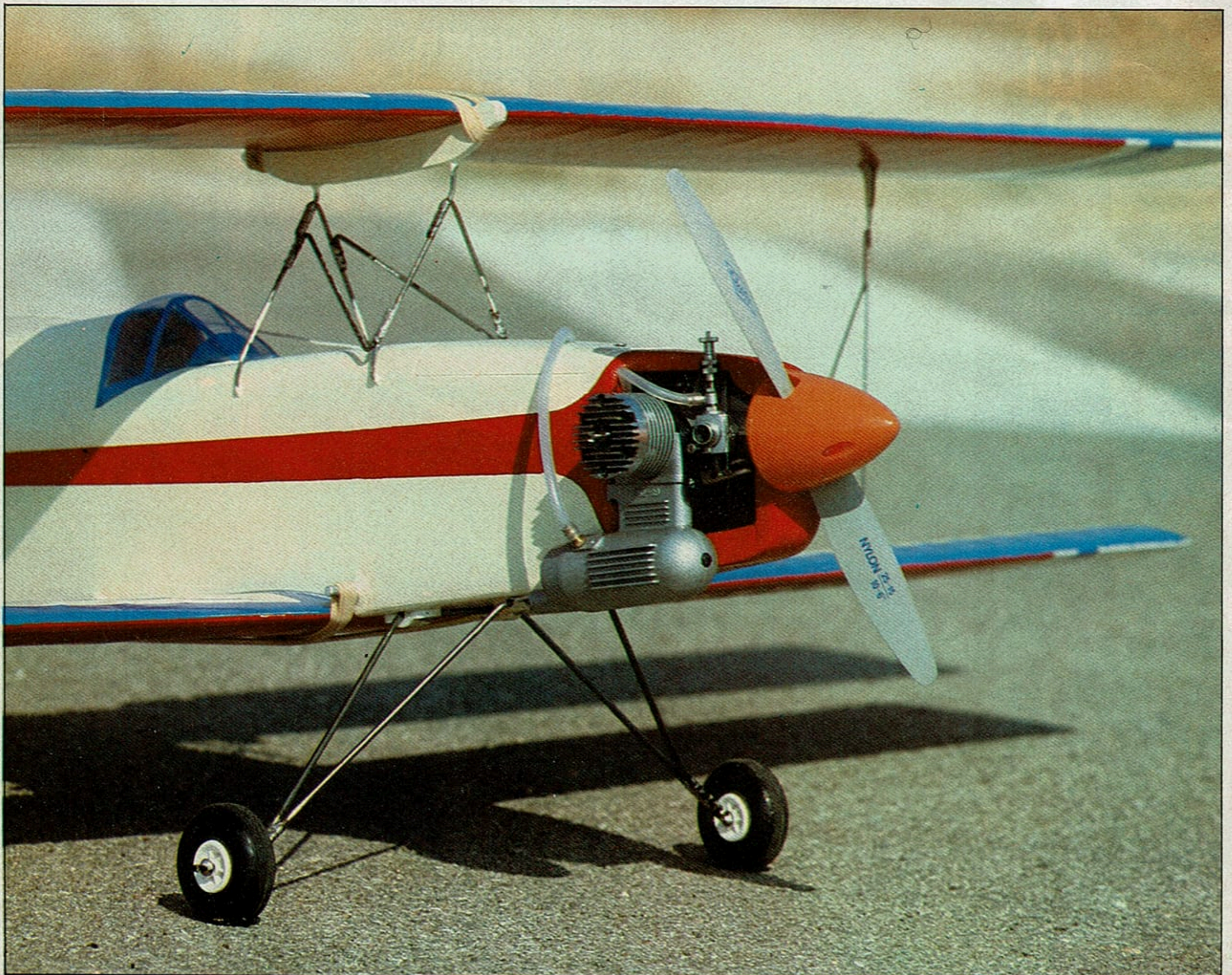
La fijación del ala superior es original, un solo punto de apoyo central y dos montantes laterales.
