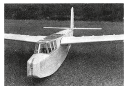
Der sauber gearbeitete Rohbau der DFS 230 (oben links und rechts). Im Vergleich zum Original ist die Rumpfspitze bei diesem Prototyp ein wenig zu eckig geraten; das sollte beim Bau des Modells berücksichtigt werden.
