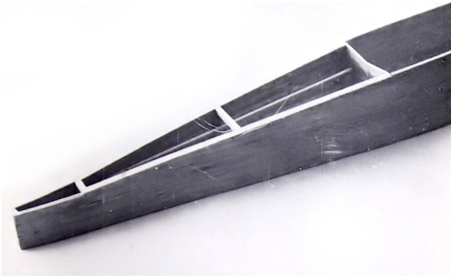
3.) Rumpfhinterteil mit eingeleimten Führungsrohren. Die Rumpfbodenteile sind bereits angeleimt.
