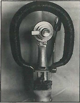
Das Steuerhorn; die Mittelsäule (Waffenauslöser) war nur bei Militärmaschinen vorhanden
