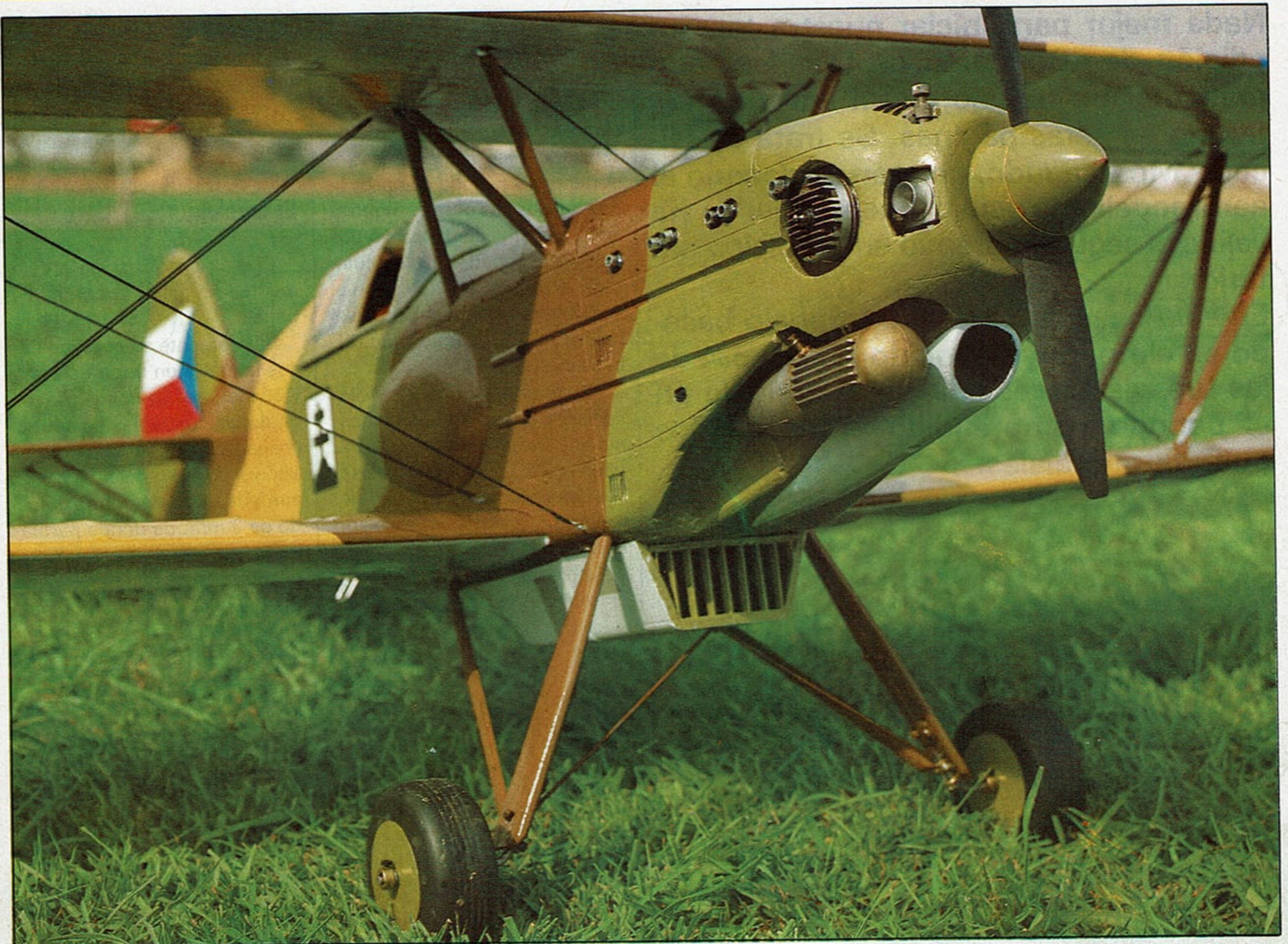
El motor cabe perfectamente dentro del capot, a excepción del escape, que precisa un alojamiento improvisado.
