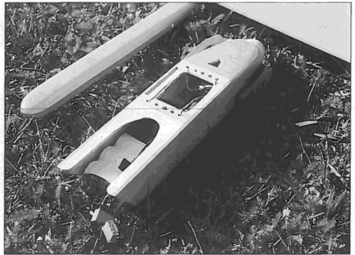
▲ Der Akkuwechsel durch die Rumpfoffnung geht im Handumdrehen
